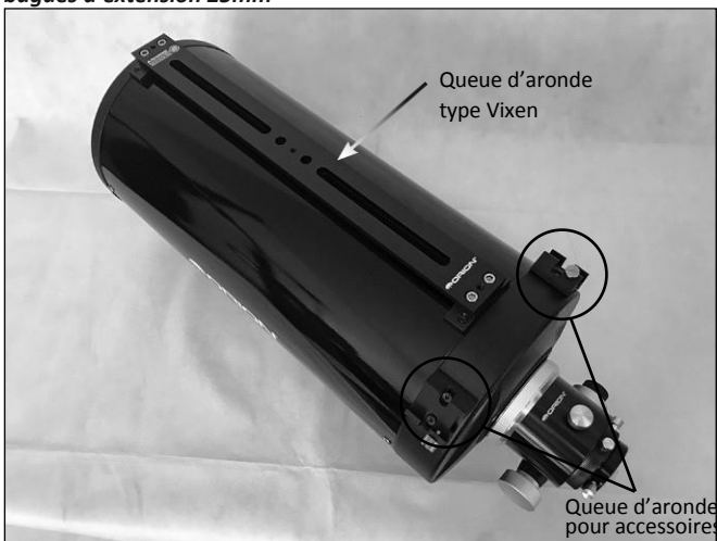
Figure 6. Les télescopes Cassegrain Kepler sont équipés d'origine de 2 queues d'aronde pour accessoires (chercheur, point rouge, mini système de guidage). Sur le 200mm, montré ici, une queue d'aronde au format Vixen est fournie de série et permet d'y monter des accessoires de guidage (lunette guide) ou un APN pour faire du grand champ (rotule fortement conseillée).
