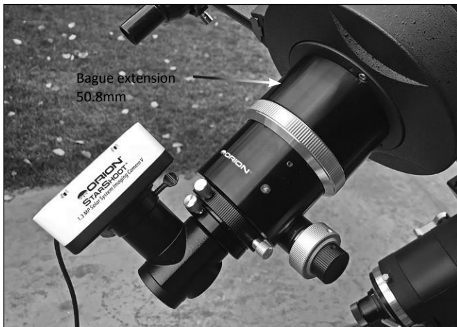
Figure 5. Pour atteindre le foyer dans cette configuration, vous aurez besoin de la bague d'extension 50mm ou des 2 bagues d'extension 25mm
